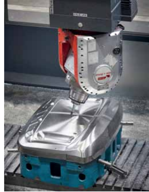
Благодаря обрабатывающей головке вилочного типа можно фрезеровать даже сложные контуры быстро и точно
