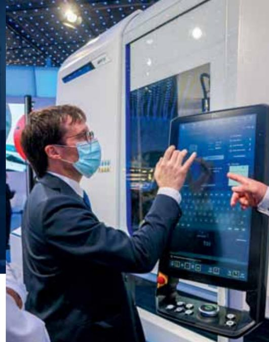
Примечательно, что панель управления C.O.R.E. – мультисенсорный дисплей, который практически не имеет клавиш. А для коррекции скорости подачи используется 16-позиционный поворотный переключатель, позволяющий регулировать оси простым поворотом.
