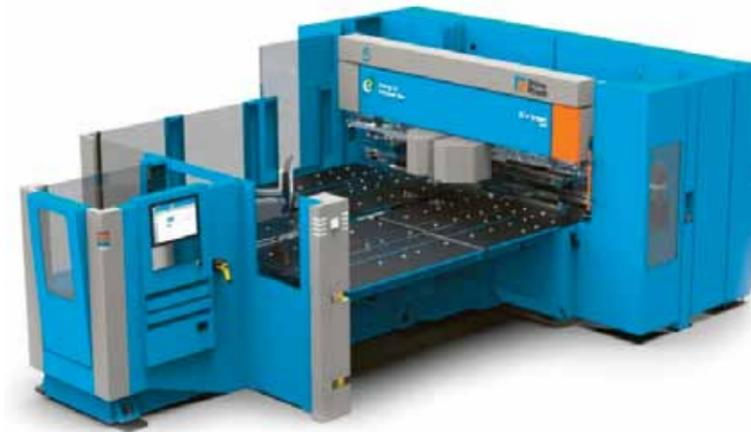
ности», который позволяет оператору сосредоточиться только на производительности. Максимальный комфорт оператора достигается благодаря двум лазерным сканерам вместо заградительных барьеров, которые раньше нужно было опустить, чтобы загрузить детали небольшого или среднего размера. Компактная компоновка машины и комбинированная последовательность загрузки и разгрузки гарантируют высокую производительность.
