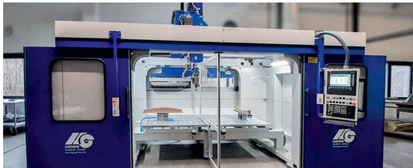
При поиске станка для фрезерования кромок деталей из пластмасс компания Krüger Aviation остановила свой выбор на 5-осевом портальном обрабатывающем центре компании HG GRIMME SysTech GmbH
