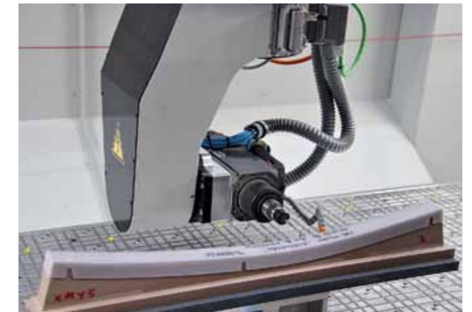
Детали очень динамично обрабатываются по контуру консольно-закрепленной фрезерной головкой
