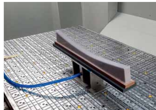
Прочный вакуумный цельнолитой алюминиевый стол, надежно удерживает заготовку даже при обработке со скоростью до 80 м/мин
