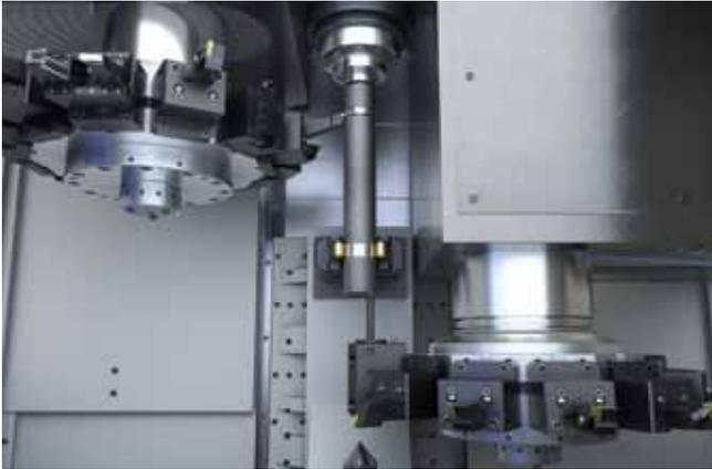
**OP 10 / 20 – Черновая токарная обработка на двух станках EMAG VTC 200 – идеальное решение для 4-х осевой обработки валов с сокращением основного времени.**
