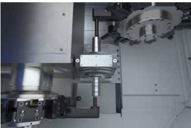
**OP 50 – Растачивание роторных валов на станке VTC 200 с центральным приводом**
