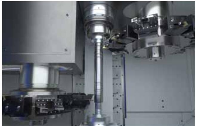
**OP 60 – Чистовая обточка и операции сверления с использованием приводного инструмента на станке VTC 200**
