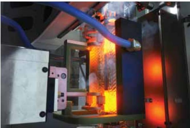
**OP 40 – Индукционная закалка посадочных мест подшипников на установке EMAG eldec MIND L 1000**
