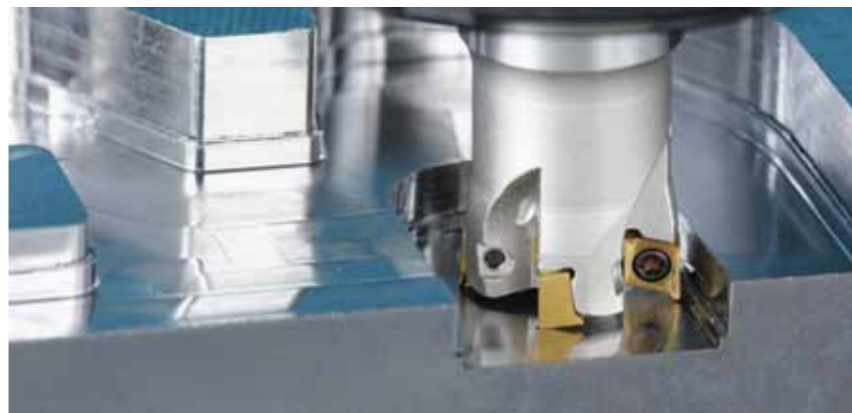
Рис. 3. Обработка уступов под углом 90° фрезами CHASE-4-MILL
