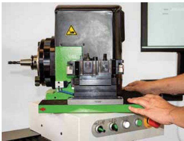
Поворотный стол KENOVA set line H343 предназначен также для специальных экспозиций и обеспечивает точность повторения - 1 мкм при позиционировании
