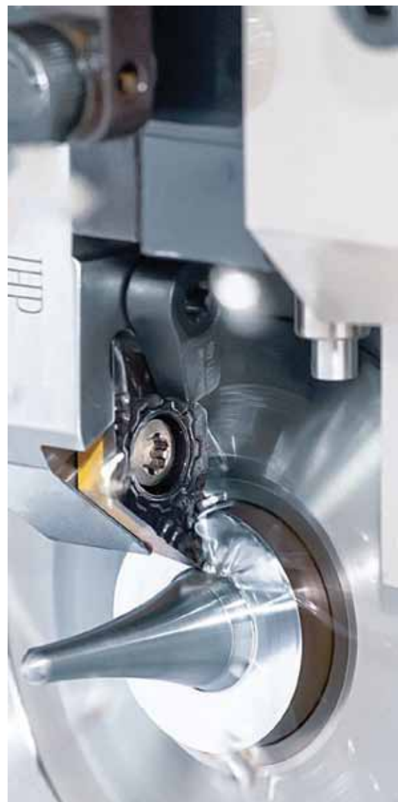
Рис. 5. Державка ISCAR с надежным винтовым зажимом пластины ромбической формы
