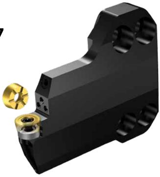
Чтобы сократить время обработки и сделать операцию более эффективной, специалисты Sandvik Coromant предложили заменить существующий инструмент на CoroTurn 107 с круглой пластиной. Благодаря методу динамического точения, инструмент вкатывается и выкатывается по радиусу, обрабатывает влево-вправо в разгонку, кроме того, ему хватало вылета для обработки кармана.
