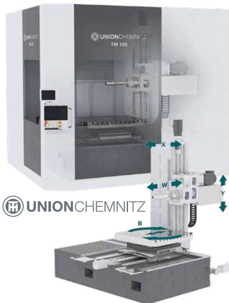
вая к скручиванию и термостабильная станина станка выполнена в виде многослойной конструкции со сварной, ребристой верхней частью, армированной волокнами минерального бетона с высокими характеристиками, напольной плиты из стали и специальных демпфирующих элементов. Поскольку между нижней и верхней частями нет металлической связи, вибрации эффективно затухают. Еще одно преимущество: минимальная потребность в пространстве.
