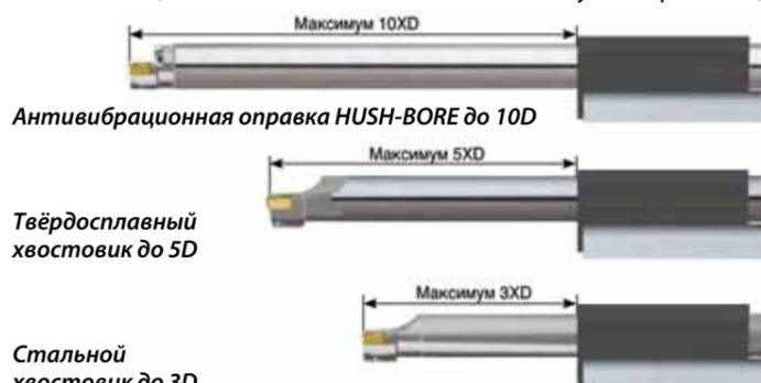
верстий с новой серией антивибрационных оправок **HUSH-BORE**. Данное высокопроизводительное решение из семейства суперсовременного инструмента линейки **SfeedTec** позволит комфортно растачивать отверстия с соотношением глубина/диаметр до 10D за счёт эффективного устранения и компенсации сил, возбуждающих колебания технологической системы.
