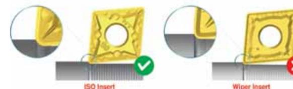
3. Используйте стандартные ISO-пластины, если возможно, так как пластины с геометрией Wiper работают с существенно более высокими усилиями резания.
