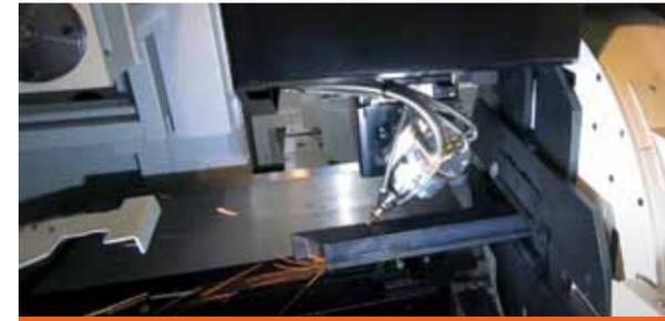
• FT-150 FIBER лазерная резка под углом 45°
