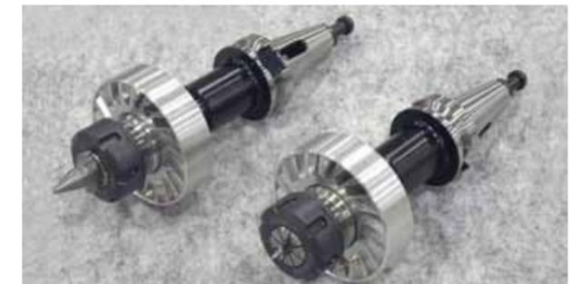
• FT-150 FIBER инструмент для термического сверления FlowDrill
