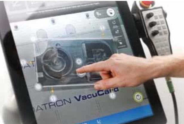
На третьем этапе оператор производит привязку к детали с помощью камеры и автоматического измерительного щупа.
