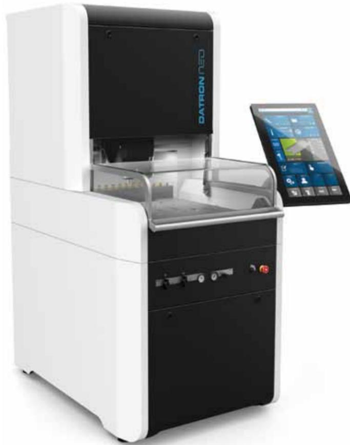
Портал и станина станка выполнены единым целым из полимербетона, обладающего минимальным коэффициентом температурного расширения и отличным вибропоглощением, что гарантирует стабильность геометрических характеристик станка.
