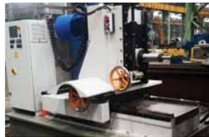
Данный проект возник в связи с потребностью предприятия в современном оборудовании, которое будет отвечать требованиям производства. Установка изготовлена в мобильном исполнении, что позволяет легко перемещать ее в нужное место и оперативно проводить текущие и плановые работы. SMO1049–01 применяется для сверления лучевых отверстий в детали типа «крышка с цапфой в сборе». SMO1049–01 имеет сертификат собственного производства выданный Белорусской ТПП.
