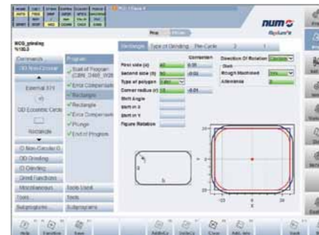
Программное обеспечение NUMgrind помогает полностью автоматизировать некруглое шлифование.
