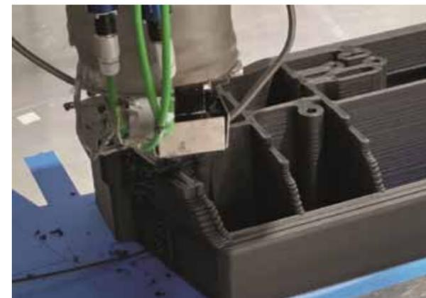
Полимеры армированы, путем применения углеродных или стекловолоконных соединений, армирование находится внутри гранул.
