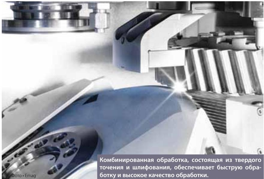
Комбинированная обработка, состоящая из твердого точения и шлифования, обеспечивает быструю обработку и высокое качество обработки.
