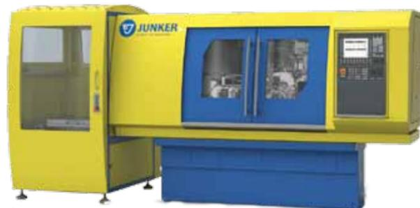
Станки серии **DRILLMAT** для изготовления спиральных сверл для профессионального применения. Благодаря пакету шлифовальных кругов достигается высочайшее качество спиральных сверл даже с самой сложной геометрией режущей кромки. Интегрированные системы загрузки и выгрузки.
