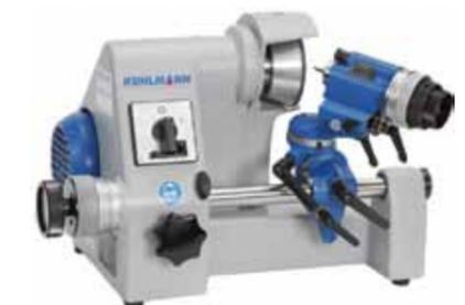
Так, экономичный прецизионный станок для фрезерования гравировальных и фасонных фрез и специальных инструментов модели **SU2** позволяет производить быстро и экономично инструмент с точной геометрией режущих кромок и с высочайшей степенью точности. Универсальность этого чрезвычайно надежного высококачественного станка соответствует всем требованиям даже в самых тяжелых условиях цеха.
