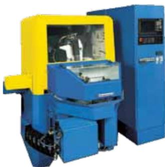
Станки **FLUTEMAT** предназначены для обработки резьбонарезных инструментов. Закрепление резьбонарезных инструментов осуществляется с помощью четырехгранного зажимного устройства и центра задней бабки. Благодаря неподвижному упору на задней бабке всегда гарантируется неизменное начало канавки. Небольшую длительность такта обеспечивает механизм правки, расположенный прямо за шлифовальным шпинделем. Он выполняет правку шлифовальных кругов в процессе, во время процедур шлифования или загрузки.
