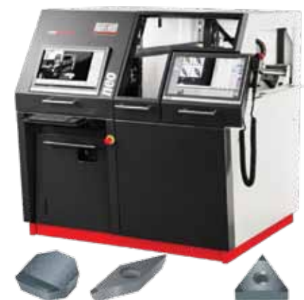
Высокоточный 5-осевой шлифовальный центр Evo Penta для обработки
