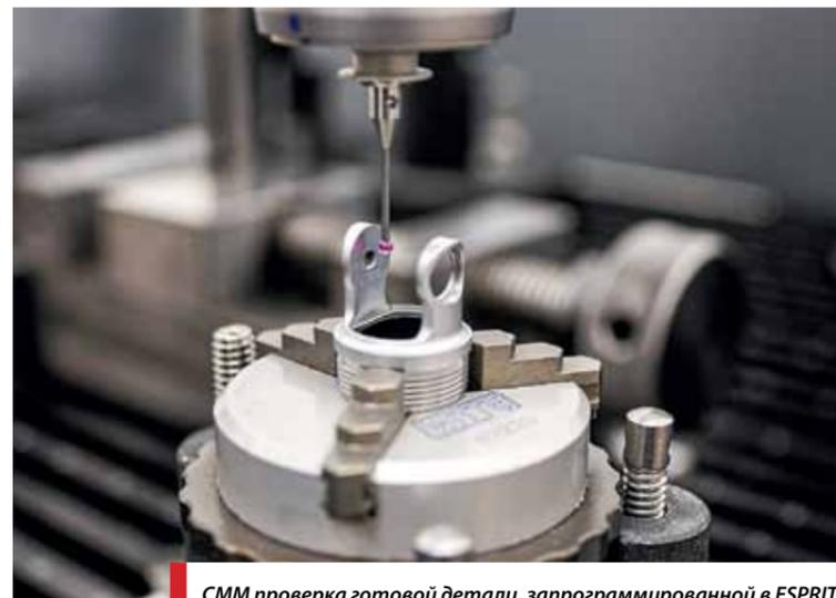
СММ проверка готовой детали, запрограммированной в ESPRIT
