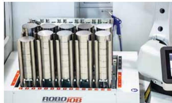
Данная модель оснащена двумя сервоуправляемыми приемными столами, способными принимать большее количество как заготовок, так и обработанных деталей
