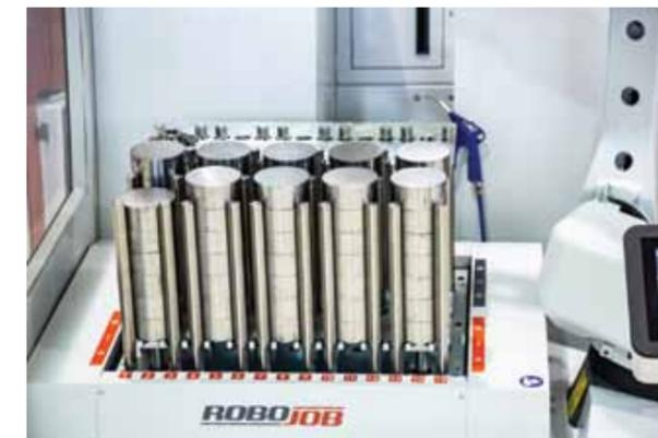
Данная модель оснащена двумя сервоуправляемыми приемными столами, способными принимать большее количество как заготовок, так и обработанных деталей
