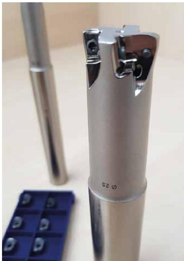
Негативная, 4-х кромочная, двухсторонняя пластина *ENMX* имеет позитивный передний угол, который снижает нагрузку и обеспечивает лучший отвод стружки.
