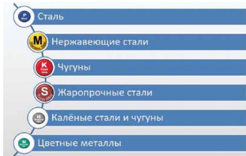
Рис. 1. Все обрабатываемые материалы согласно ISO делятся на шесть групп, с соответствующим буквенным индексом
