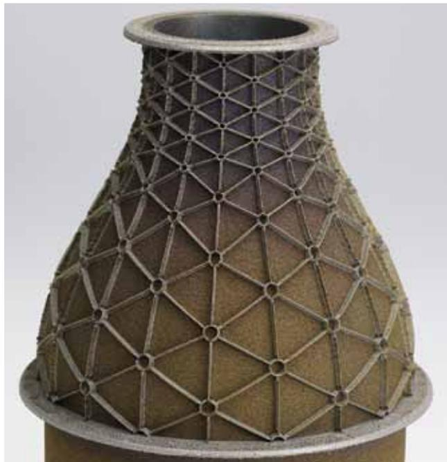
Компонент соплового аппарата турбины, изготовленный с помощью hyperMILL® ADDITIVE Manufacturing
