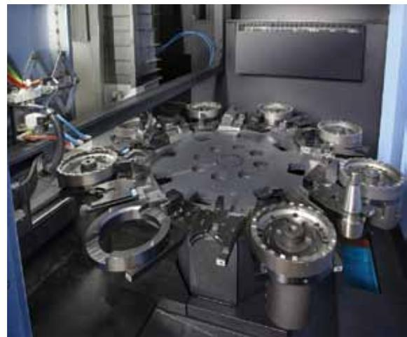
**PUMA VTR1012F** поставляется с магазином инструмента большой емкости (24 позиции). Четырехместный резцедержатель уменьшает количество операций, сокращая длительность цикла обработки. Кроме того, оборудование оснащено устройством автоматической смены инструмента, что обеспечивает максимальную производительность при его эксплуатации.
