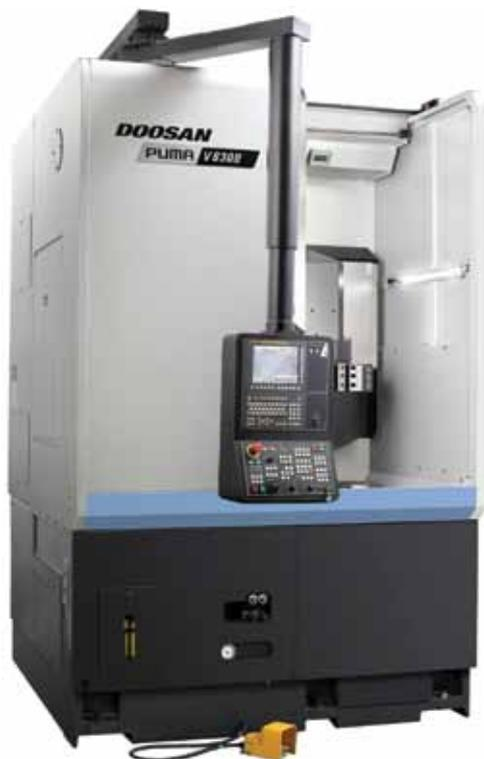
**PUMA V8300 – вертикальный токарный центр для тяжелых режимов** превосходит своего младшего брата ОЦ PUMA V400 по всем параметрам и диапазон его применения существенно расширен. Жесткая конструкция станины, на которой размещены направляющие скольжения коробчатого типа, и большой крутящий момент позволяют легко справляться с труднообрабатываемыми материалами.
