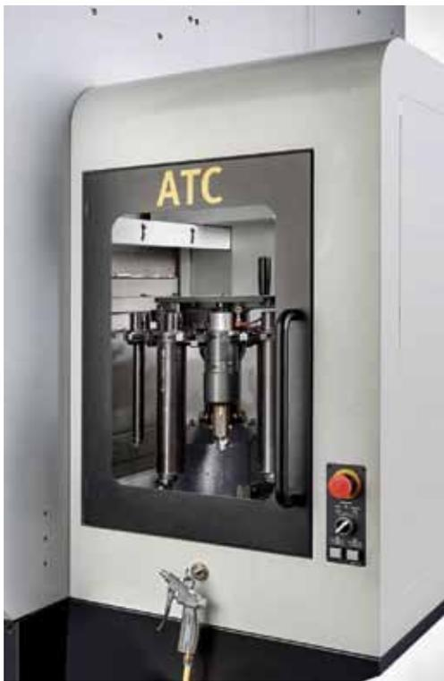
**PUMA VTR1216 – вертикальный токарно-карусельный станок** с подвижной поперечной балкой и осью *W* предназначен для обработки более габаритных деталей, чем предыдущая модель. Чем выше оборудование, тем шире номенклатура производимых на нем изделий. Таким образом, выбор между конструкцией с фиксированной балкой или с осью *W* будет напрямую зависеть от производственных задач предприятия.
