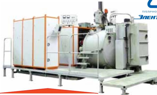
«ВИП-НК» - вакуумная индукционная установка для направленной кристаллизации полунепрерывного действия. Установка предназначена для литья лопаток из специальных жаропрочных сплавов, кристаллизирующихся с низкими скоростями при высоких термических градиентах, а также для высокоскоростной направленной кристаллизации.
