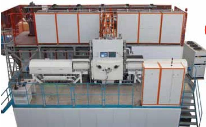
«УЭн-500» – вакуумная электронно-лучевая установка предназначена для нанесения однослойных и многослойных металлических, окисных, карбидных покрытий на различные изделия. Такие покрытия позволяют эксплуатировать изделия при более жестких условиях по сравнению с незащищенными. Установка «УЭн-500» позволяет также получать конденсат материалов, производить переплав заготовки.
