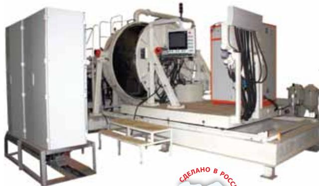
«Гранула (УЦР)» – установка центростремительного распыления предназначена для получения металлических порошков высокорекреакционных металлов, жаропрочных никелевых и титановых сплавов методом центростремительного распыления заготовок, оплавления плазменным нагревателем в среде инертных газов с одновременной транспортировкой получаемых порошковых материалов в объемную герметичную емкость без контакта с воздухом.
