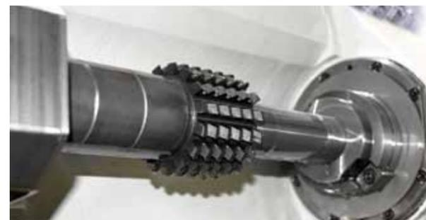
С началом обработки деталей на станке R 300 время стойкости используемых червячных фрез повысилось примерно на 30%
