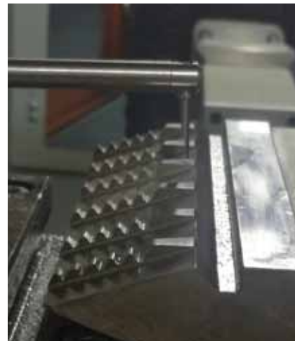
Измерение профиля протяжки контурографом
