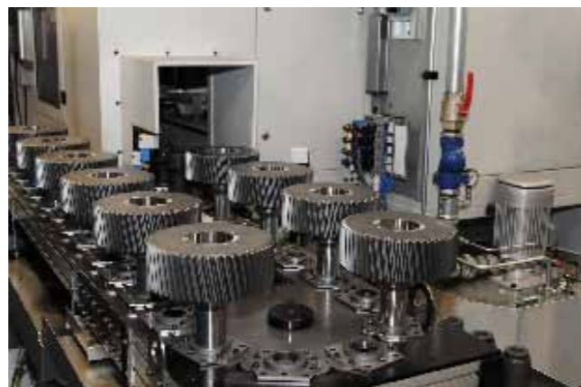
Рис. 3. Компания Gleason адаптировала загрузочное устройство для станка 300TWG, на которое очень легко установить требуемую оснастку, подходящую для держателей заготовок, используемых компанией ZaTeC. Незаметное переключение между загрузкой вручную или с помощью крана и автоматической загрузкой минимизирует время простоя – даже при последовательной обработке небольших партий, штучном или серийном производстве.
