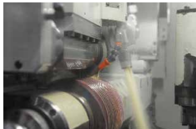
Рис. 2. Примерно 15 минут требуется на профилирование абразивного червячного круга в соответствии с параметрами заказа с помощью инструмента для правки профиля. Подобная технология экономит несколько недель, требуемых для изготовления абразивного червяка в соответствии с характеристиками заготовки.
