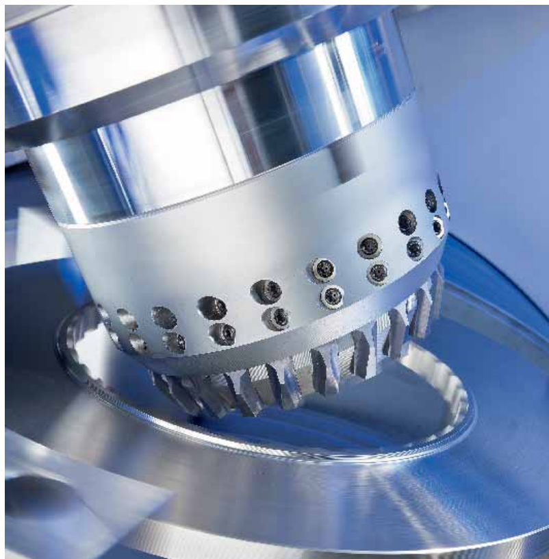
Рис. 1. Прорыв в зуботочении: технология стержневых ножей стала той основой, которая позволила компании довести этот метод до технологической готовности
