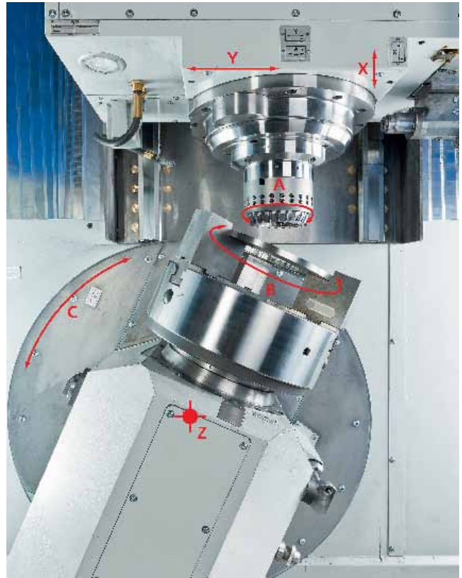
Рис. 4. Зубочерчение на зубофрезерном станке для спиральнозубых конических колес Oerlikon C 29
