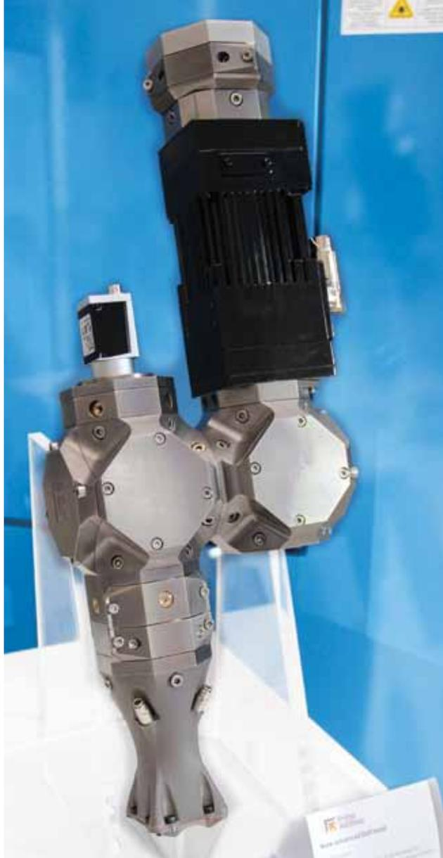
**Новая инновационная лазерная головка Prima Additive предназначена для выполнения широкого спектра работ по технологии порошкового синтеза DED**
