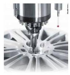
делем с частотой вращения 54 000 мин<sup>-1</sup> и крутящим моментом до 23 н/м, в то время как у обрабатывающих центров 18 серии в стандартном исполнении – до 300 н/м.
