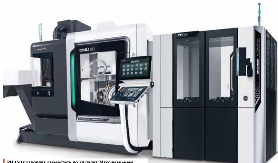
PH 150 позволяет разместить до 24 палет. Максимальный размер палет ø 500 x 500 мм с весом заготовки до 250 кг
