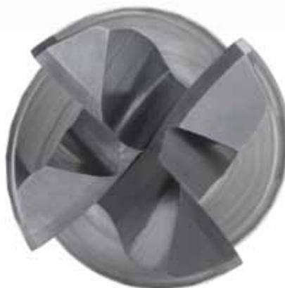
*Большая часть успеха фрезы HARVI I TE определяется наличием инновационной геометрии торца. Увеличенная надежность вершин зубьев фрезы позволяет выполнять плавное резание даже при самых высоких углах наклона.*
