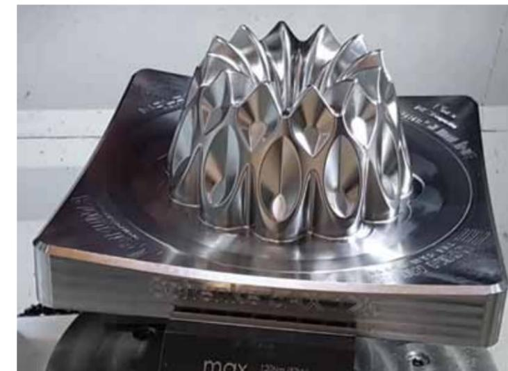
шкалу. В дополнение к аппаратным средствам в новой машине традиционно нашли применение интеллектуальные технологии OKUMA, такие как Machining Navi для снижения вибраций при обработке или система 5-осевой автокоррекции для компенсации геометрических погрешностей, которые дополнительно также повышают точность станка. В результате GENOS M460V-5AX достигает точности позиционирования 2 мкм по осям X, Y и Z.
