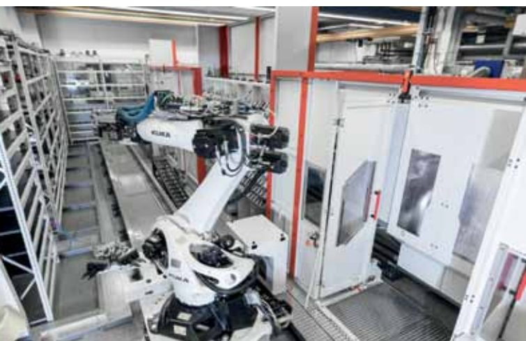
Вид сверху универсальной производственной ячейки с магазином для палет заготовок слева и сзади, магазином на 200 инструментов справа, подсоединением для обрабатывающего центра С 42 U справа спереди и многофункциональным роботом посередине в качестве манипулятора для палет заготовок и инструментов
