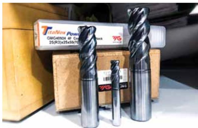
Характерной особенностью фрез серии **TitaNox-Power** является двойная геометрия сердцевинки, см. рисунок. В сечении X-X' выполнена глубокая стружечная канавка, что позволяет эффективно удалять стружку из зоны резания при работе в паз. В сечении Y-Y' диаметр сердцевинки значительно увеличивается, что повышает жёсткость инструмента. Благодаря этому мы можем одной и той же фрезой работать в паз и методом бокового фрезерования на максимальных режимах резания.
