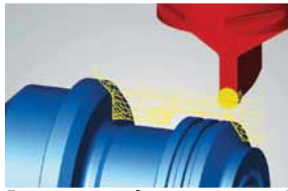
Повышение производительности токарной обработки: эффективная черновая обработка благодаря трохоидальным траекториям движения инструмента
