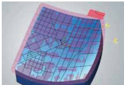
Тангенциальная обработка: автоматическое объединение поверхностей по заданному ISO-направлению
