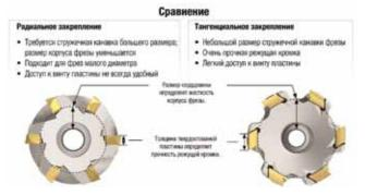
Корпуса фрез обеспечивают внутренний подвод СОЖ и представлены в исполнениях со средним и крупным шагом зубьев диаметром от 50 до 200 мм. Большие возможности по глубине резания, от 0,5 до 12 мм, позволяют фрезе Mill 4-12КТ работать в широком спектре операций по обработке уступов. Высокие показатели производительности, даже при обработке в тяжелых условиях, стали возможны благодаря следующим особенностям фрезы:
