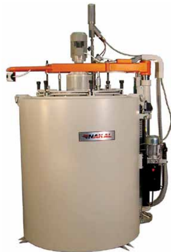
СЭОА – печь для каталитического газового азотирования
