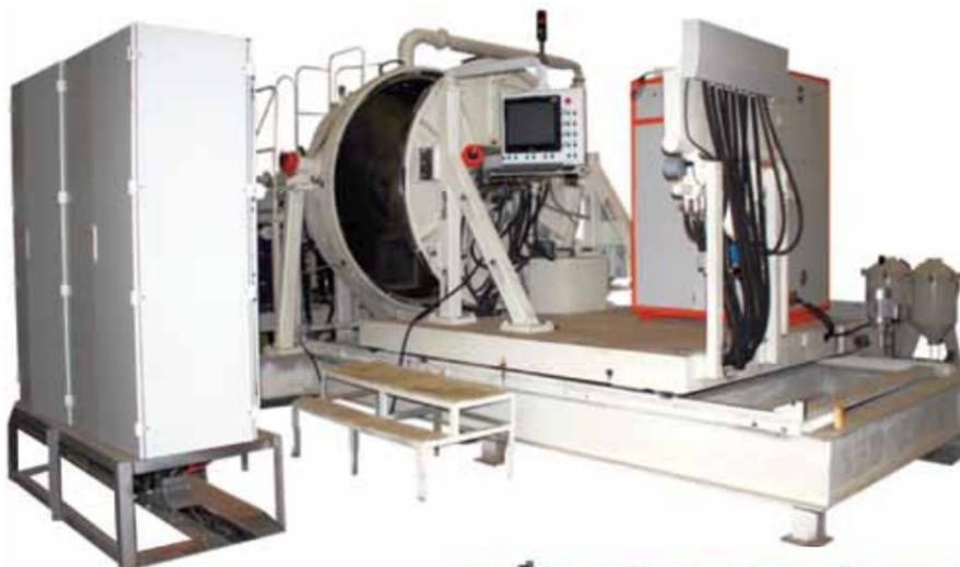
«Гранула (УЦР)» – установка центробежного распыления предназначена для получения металлических порошков высокорепродуцируемых жаропрочных никелевых и титановых сплавов методом центробежного распыления заготовок, оплавленных плазменным нагревателем в среде инертных газов с одновременной транспортировкой получаемых порошковых материалов в объемную герметичную емкость без контакта с воздухом.
