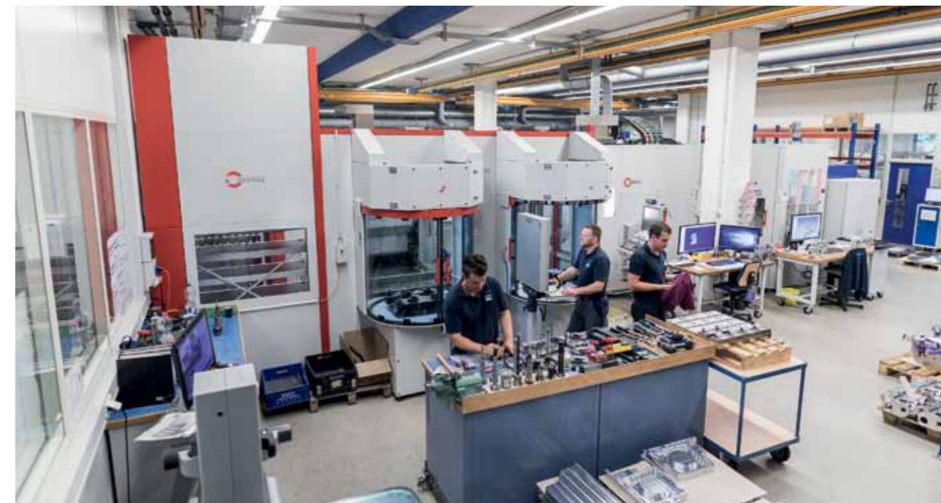
Вид спереди универсальной производственной ячейки с тремя полностью интегрированными 5-осевыми высокопроизводительными обрабатывающими центрами С 42 U с ЧПУ, роботизированной системой RS2-L и двойным магазином для хранения и загрузки заготовок и инструментов; посередине находятся обе станции оснастки
