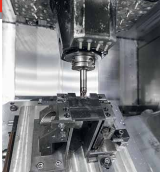
Рабочая зона 5-осевого высокопроизводительного обрабатывающего центра С 42 U с ЧПУ, наклонно-поворотным столом диаметром 800×630 мм и закрепленным на палете зажимным устройством для 5-осевой обработки заготовки
