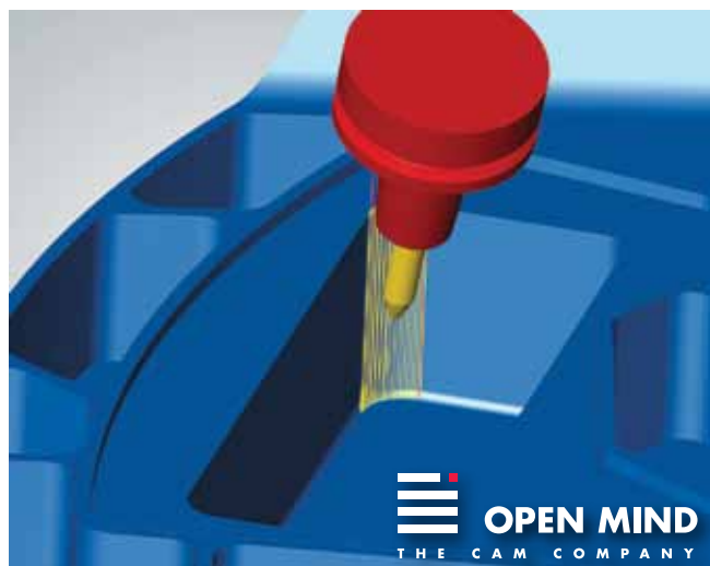
Коническая барабанная фреза: чистовая обработка призматических скруглений на крайне высокой скорости подачи
