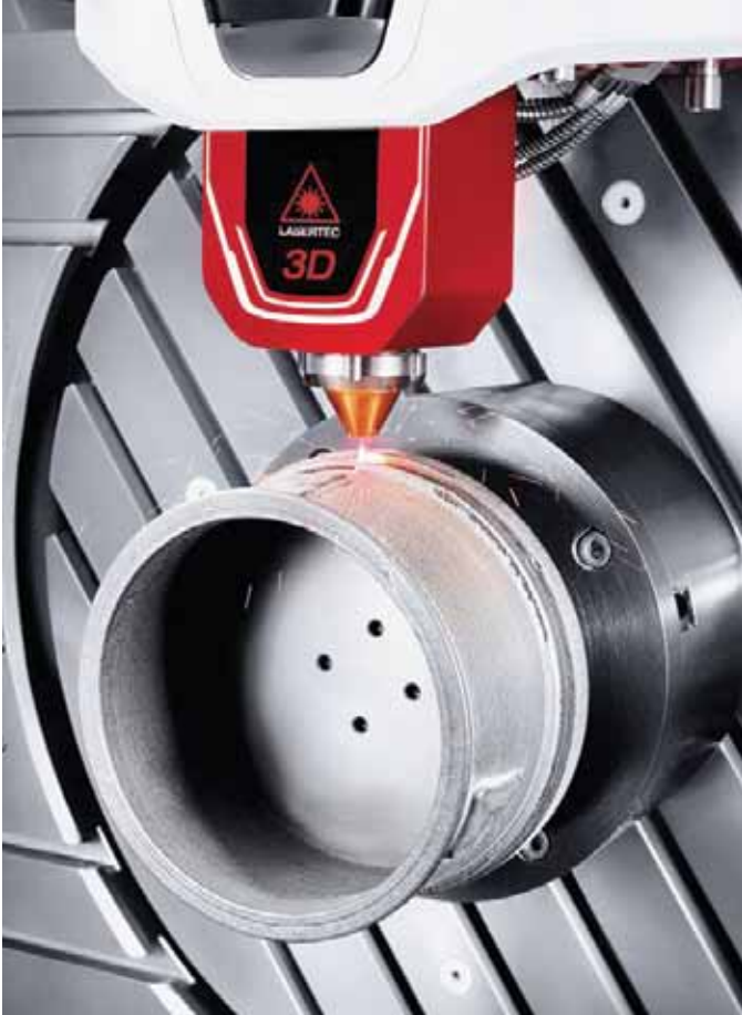
Линейка оборудования DMG MORI состоит из четырех полных технологических цепочек для аддитивного производства с использованием порошковой камеры и сопла подачи порошка
