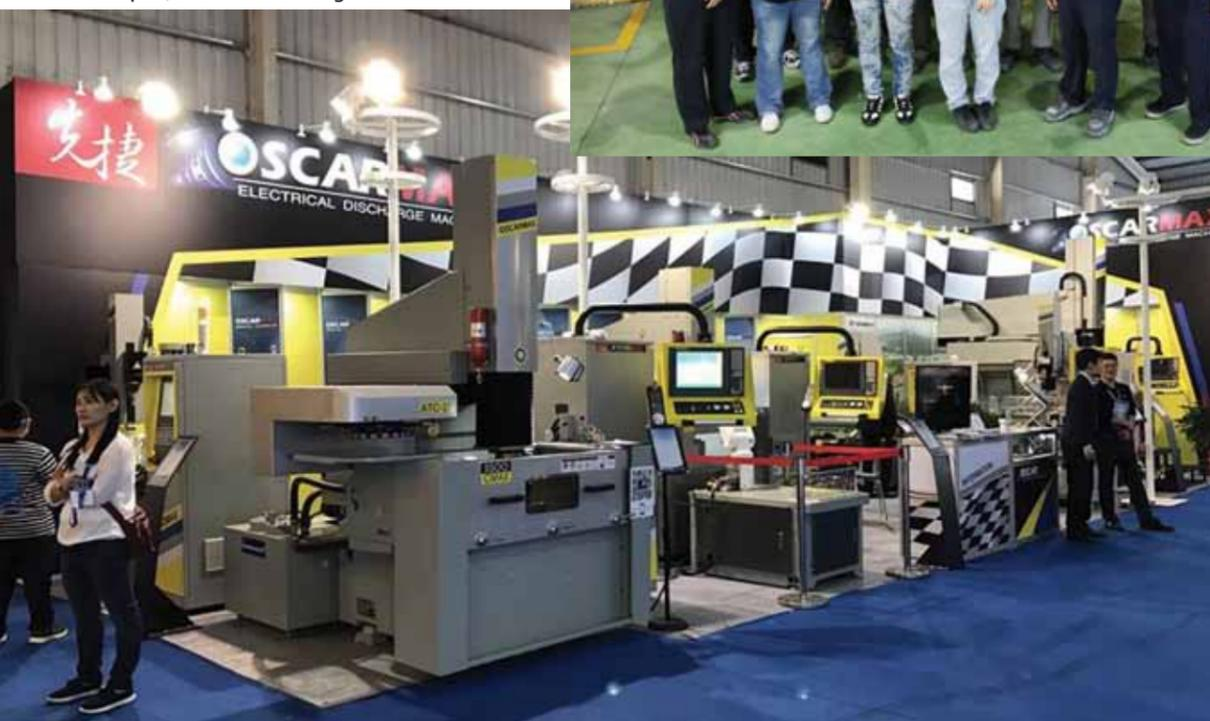
Третьим инновационным достижением Oscarmax является многоэлектродная система автоматической смены инструментов, которая вмещает до 80 позиций (электродов) и оснащается роботизированными манипуляторами и направляющими. Электроэрозионный станок взаимодействует со всеми системами, в том числе с автоматическими устройствами подачи. Подобная компоновка обеспечивает максимальную автоматизацию процессов, которая идеально вписывается в новую концепцию самых современных предприятий и заводов.
