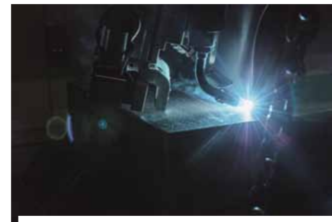
Лазерный луч разогревает поверхность детали, что обеспечивает глубокое проплавление в узкой зоне. Затем электрическая дуга формирует широкую сварочную ванну, обеспечивая хорошее перекрытие зазоров
