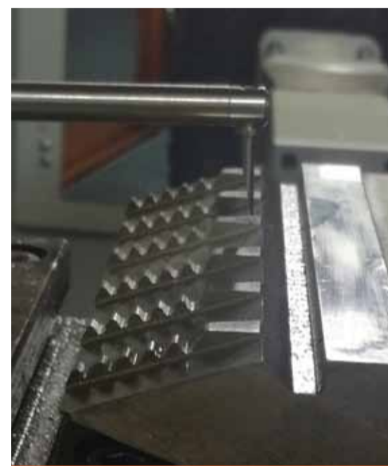
Измерение профиля протяжки контурографом
