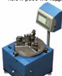
Прибор мод. БВ-7661 для контроля осевого зазора подшипников
