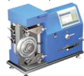
Прибор мод. БВ-7660 для контроля радиального зазора подшипников
