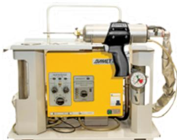
Металлические покрытия формируются на детали при воздействии на нее сверхзвуковым потоком металлических частиц. Достоинством технологии ДИМЕТ® является незначительный нагрев детали при нанесении покрытия, что не вызывает внутренних напряжений и деформации детали.
